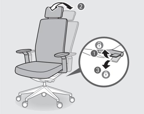
Сяд на кресле, потяните на себя рычаг регулировки слева под сиденьем (1). Установите нужный угол наклона спинки, откинувшись на нее (2). Зафиксируйте положение, повернув рычаг от себя (3) до характерного щелчка.
