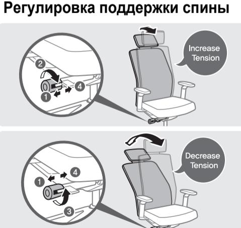
Сяд на кресле, потяните наружу шток регулировки справа под сиденьем (1). Покрутите шток по часовой или против часовой стрелки для регулировки усилия натяжения механизма наклона (2, 3). Зафиксируйте настройки, вернув шток в исходное положение (4).
