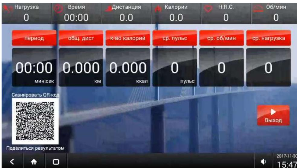
При нажатии кнопки "STOP" тренировка будет остановлена, система выведет на экран общее время, дистанцию, калории, средний пульс, среднее значение об/мин и средний уровень нагрузки. Система считывания результатов тренировки при помощи QR кода позволяет поделиться информацией с друзьями.
